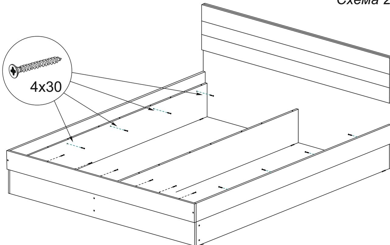
4. После сборки каркаса кровати, для придания конструкции жесткости, соедините между собой царги №1, №2 и №3 с настилом №6 евроинтами, как показано на схеме 3.
